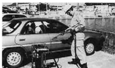
従来のガス切断器と異なり、アルミニウム、真ちゅう、ステンレスなどの各種金属や、スラブを素早く溶解切断することが出来る万能型の切断装置です。
