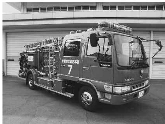
化学車は、主に油脂火災の消火活動を目的にした消防車で、1,300ℓの水と500ℓの泡消火薬剤を積載しています。
