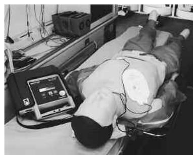
高性能の心電図自動解析装置を内臓しており、心肺停止状態の傷病者に対して、効果的な電気ショックを与えることができます。
