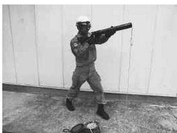
救命索発射銃は、高所、水面などの孤立した場所へ人命救助用ロープを展開したり、おぼれている人に対して着水後に膨張浮上する救命用浮環を展開するための、救助用ロープを目的の場所に誘導する救命索のついた発射体を発射する特殊な銃です。
