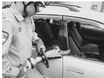
大型油圧式救助器具は、油圧ポンプをラムシリンダーを高圧ホースで接続したもので、ラムシリンダーに各種のアタッチメントを組み合わせることで取り付け、持ち上げ、広げ、押さえつけ、引っ張り、締めつけ、切断の操作ができ、交通事故などの人命救助や破壊工作などに使用されています。
