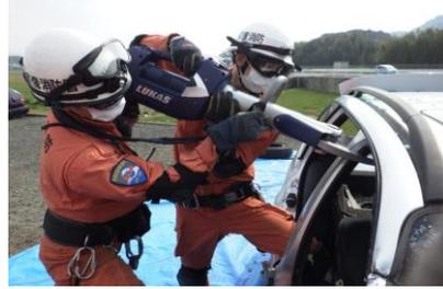
バッテリー式の電動油圧救助器具で、持ち上げ、広げ、押さえつけ、引っ張り、締めつけ、切断の操作ができ、交通事故などの人命救助活動に使用します。
