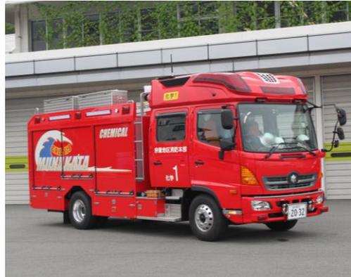
主に油脂火災の消火活動を目的にした消防車で、1,500ℓの水と500ℓの泡消火薬剤を積載しています。
