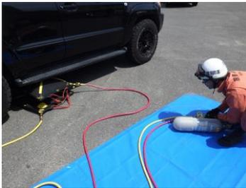
空気ポンプ、ホース、マット等を用いて、重量物の持ち上げや変形したドアの開放などに使用します。
