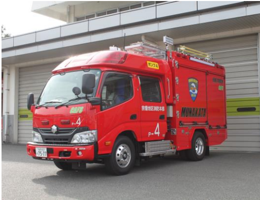
圧縮空気泡消火装置搭載型 消防ポンプ自動車
